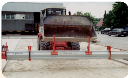
Einfacher Transport des montierten Planierhobels
